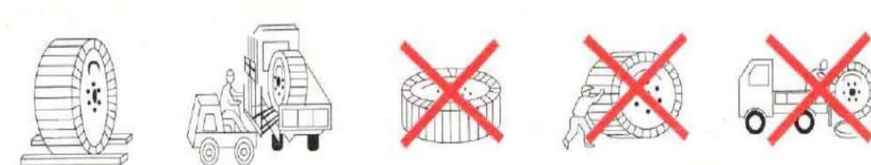
Schéma manipulace s OPGW (Obrázek 1)
